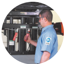
Пневмогидравлическая траверса грузоподъемностью 4 т
