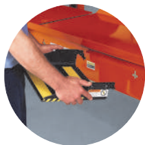
Переставная ступенька для измерения кастера
